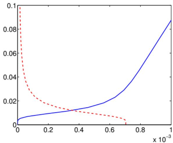
— :  $2\langle\nu_t\bar{s}_{12}\rangle$ ; - - - :  $\nu\frac{\partial\langle\bar{u}\rangle}{\partial y}$ ; - · - :  $-\langle\bar{u}\bar{v}\rangle$ ; ○:  $2\langle\nu_t\bar{s}_{12}\rangle - \langle\bar{u}\bar{v}\rangle$ .
