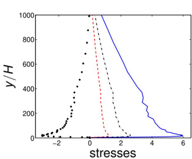
— :  $u_{rms}^+$ , - - :  $v_{rms}^+$ , - - - :  $w_{rms}^+$
