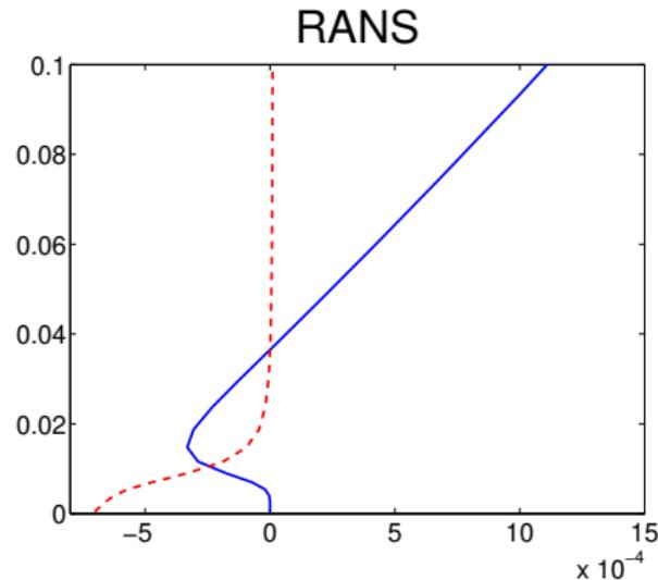
— :  $2\langle\nu_t\bar{s}_{12}\rangle$ ; - - - :  $\nu\frac{\partial\langle\bar{u}\rangle}{\partial y}$ ; - · - :  $-\langle\bar{u}\bar{v}\rangle$ ; ○:  $2\langle\nu_t\bar{s}_{12}\rangle - \langle\bar{u}\bar{v}\rangle$ .
